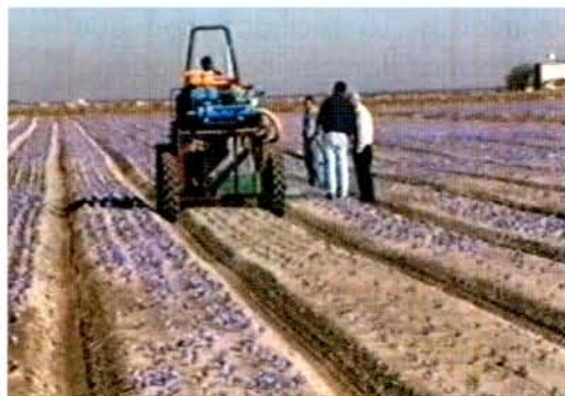
Ensayo de un prototipo para la siega mecanizada de la flor del azafrán. Fotografía tomada en la finca El Safranal, propiedad de la Compañía General del Azafrán de España, en Quero, Toledo
