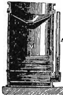
Figura 5.ª—Interior del pluviómetro.
